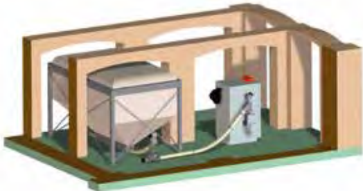
Flexilo® TROG mit Übergabe auf Querspirale als Direktbeschickung
