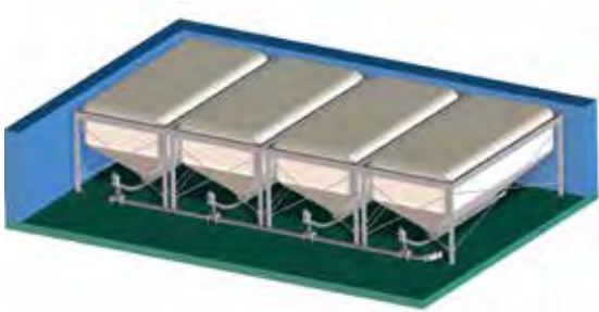
4 Flexilo® TROG mit Übergabe auf Querspirale mit Absaugpunkt
