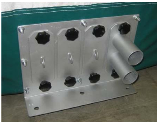
Saugbahnhof im Silo
